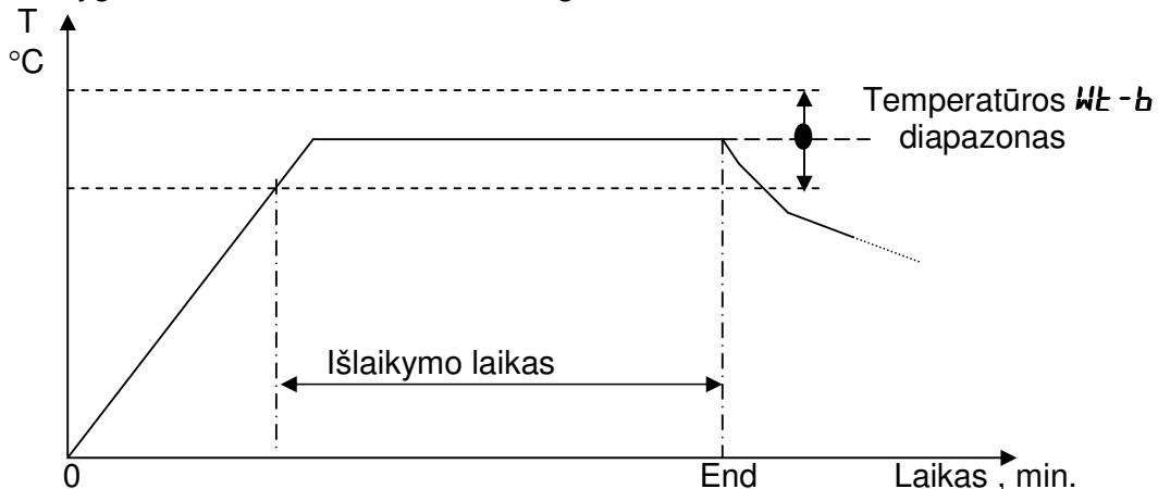
**AT:** automatinis temperatūros reguliavimo parametru ( PID dėsnio parametru : **P** , **I** , **d** ) parinkimas (toliau tekste : AT ) . Jei temperatūra krosnies kameroje svyruoja ir nestabili , tai būtina įjungti AT. AT gali būti įjungtas tik tada , kai regulatorius vykdo programą.
