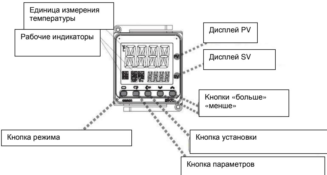
«PF» каждое нажатие этой кнопки меняет цифру значение устанавливаемого параметра
