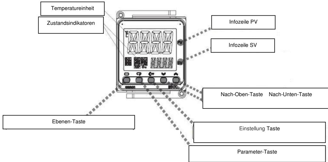
„PF“ Druckknopf: bei jedem Druck dieses Druckknopfes wird die Zahl des einstellbaren Parameters geändert
